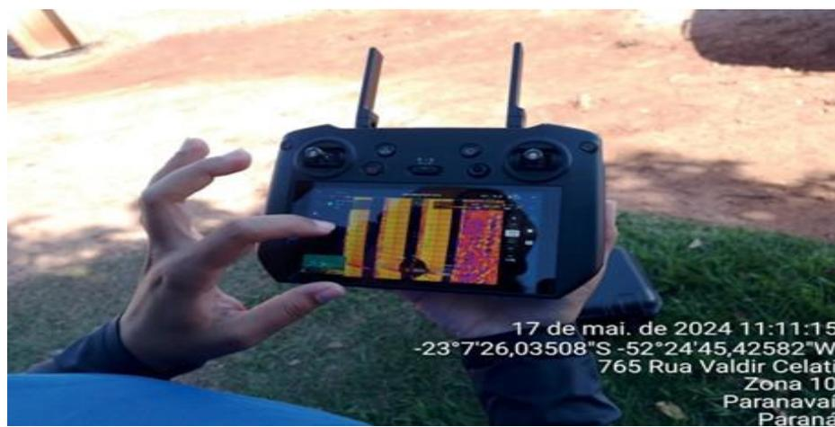
**PREPARAÇÃO** - Utilizamos um drone Thermal da DJI com câmera de alta resolução. O voo do drone foi programado com waypoints, as condições meteorológicas foram cheçadas assim como o melhor horário para atividade, com posse dos dados de operação da UFV no momento das atividades.
